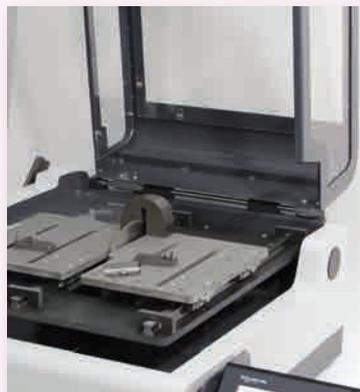
Die Flexicut kann an eine Absaugung angeschlossen werden.
