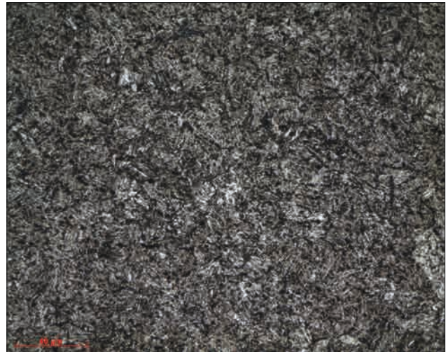
Abb. 23: Martensitisches Härtegefüge nach dem Anlassen Objektiv x50
