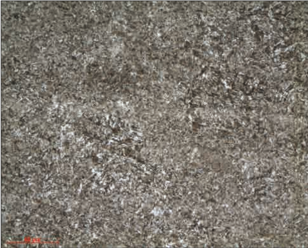
Abb. 22: Martensitisches Härtegefüge - Objektiv x50
