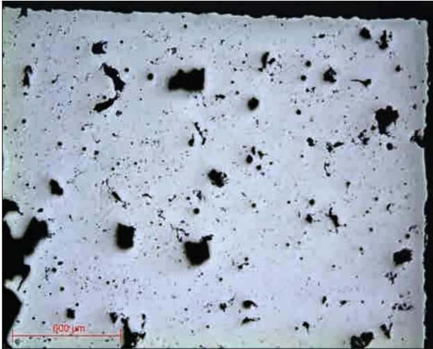
Mikroskopische Aufnahme 21: Polierte Aluminiumlegierung im Zustand SPM-Linse x5
