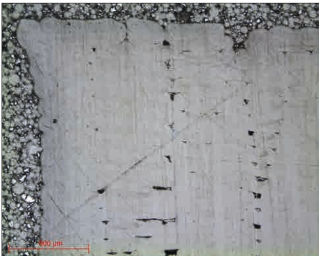
Mikroskopische Aufnahme 1: PLA - Oberflächenzustand TOP 9µm Objektiv x5
