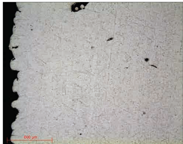
Mikroskopische Aufnahme 13: Titanlegierung - Oberflächenzustand TOP 9µm Objektiv x5
