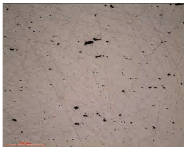
Mikroskopische Aufnahme 5: Legierung von Kobalt-Chrom - Oberflächenzustand TOP 9µm Objektiv x5
