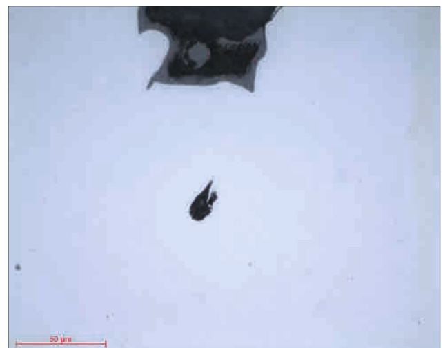
Mikroskopische Aufnahmen 17 und 18: Titanlegierungen, poliert im Zustand SPM-Linse x20 und x50
