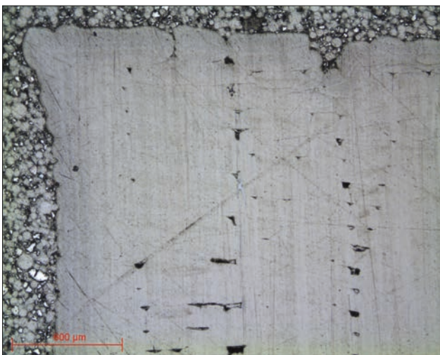
Micrographie 1 : PLA - Etat de surface TOP 9µm obj x5
