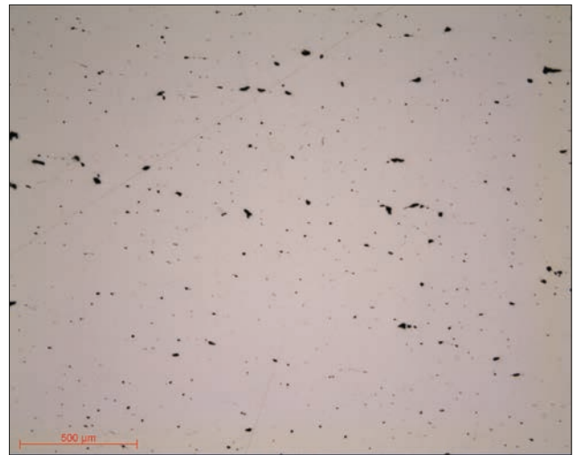
Micrographie 7 : Alliage de Cobalt-Chrome - Etat de surface NT 1µm obj x5
