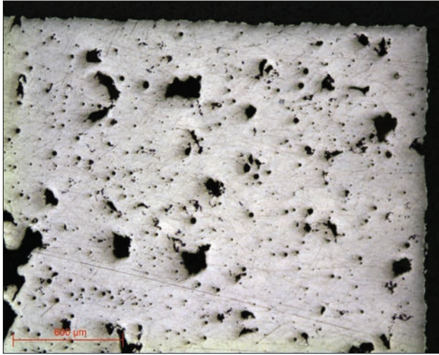
Micrographie 10 : Alliage d'aluminium – Etat de surface NT 1µm obj x5
