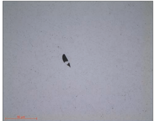
Micrographie 16 : Acier inoxydable poli à l'état 1µm obj x50
