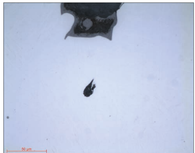
Micrographies 17 et 18 : Alliages de titane polis à l'état SPM obj x20 et x50
