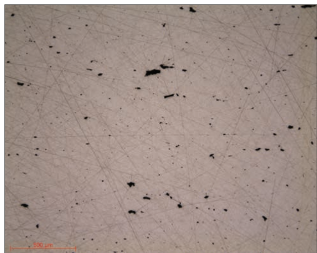
Micrographie 5 : Alliage de Cobalt-Chrome - Etat de surface TOP 9μm obj x5
