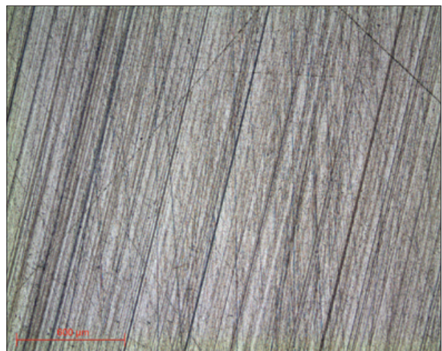
Micrographie 10 : Etat de surface I-Max R 18µm obj x5
