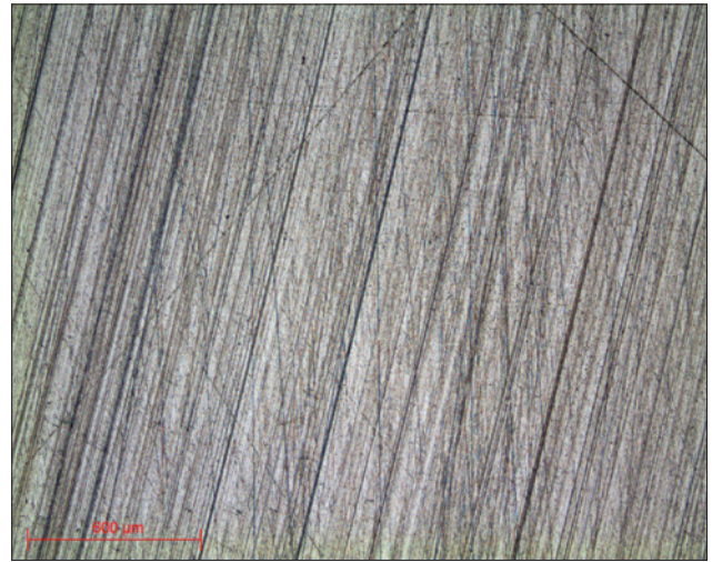
Mikroskopische Aufnahme 7: Oberflächenzustand I-Max R 18µm Objektiv x5
