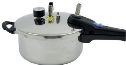
Fig 5 : Appareil d'enrobage sous pression
