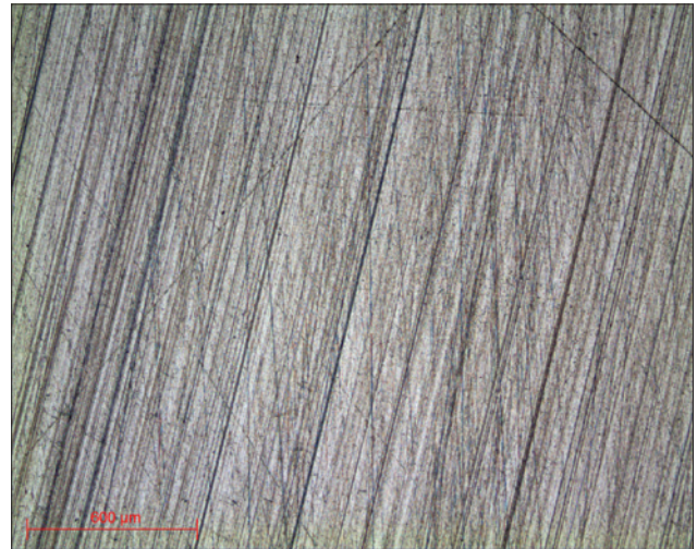
Micrographie 7 : Etat de surface I-Max R 18µm obj x5
