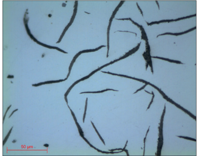
Abb. 16: Gusseisen GJL - Objektiv x50
