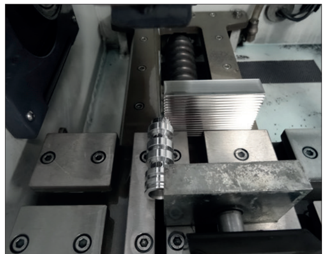
Abb. 7: Spannen einer Nockenwelle - T210
