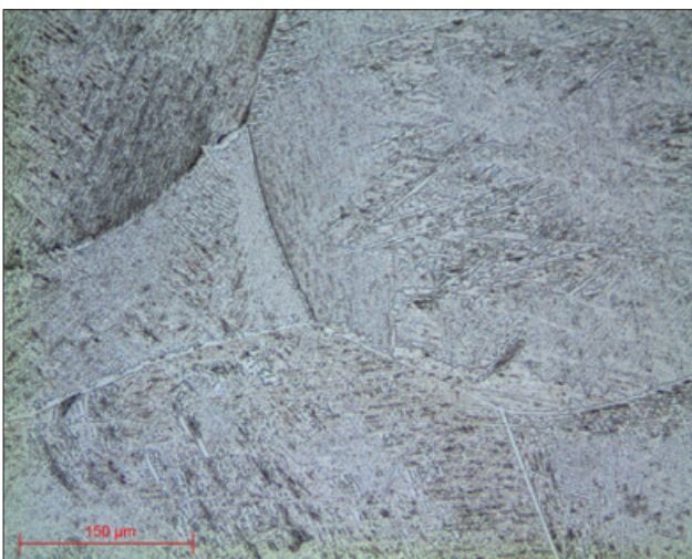
Mikroskopische Aufnahme 14: TA6V, behandelt mit Kroll - Objektiv x20 Reagenzätzen
