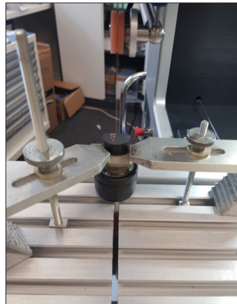
Abbildungen 15 und 16: Beispiele für Klemmung und elektronischen Steckverbinder - Drahtsäge der Serie 4000
