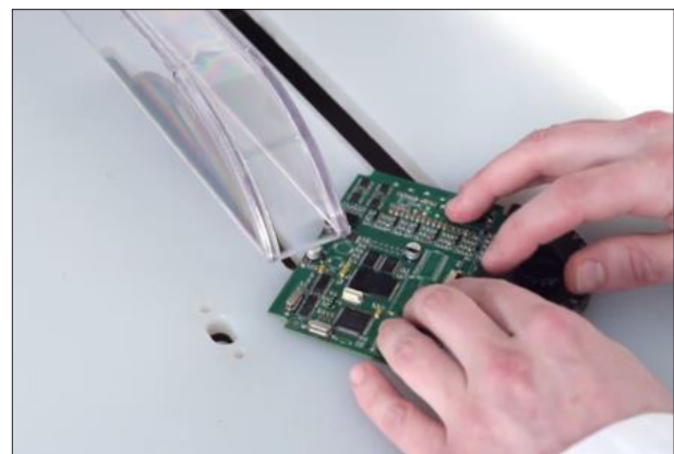
Abbildungen 12 & 13: Beispiele für die Klemmung einer elektronischen Schaltung - FLEXICUT
