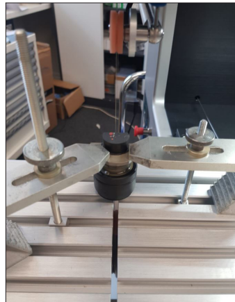
Figure 15 et 16 : Exemples d'un bridage d'un connecteur électronique - Scie à fil série 4000
