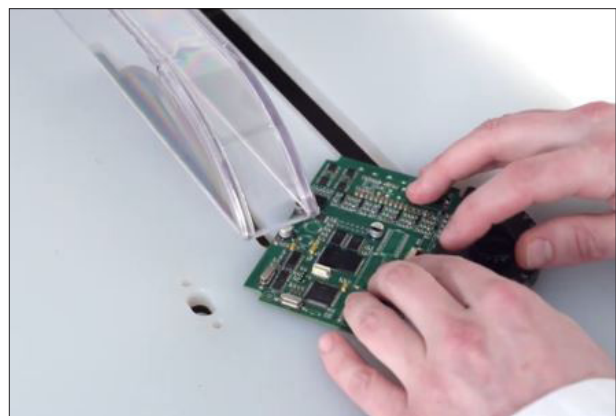
Figure 12 et 13 : Exemples de bridage d'un circuit électronique - FLEXICUT
