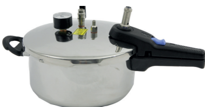
Fig 8 : Appareil d'enrobage sous pression
