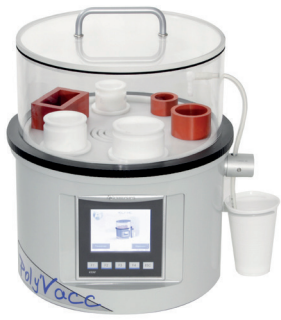
Fig 9 : Appareil d'enrobage sous vide POLY'VAC
