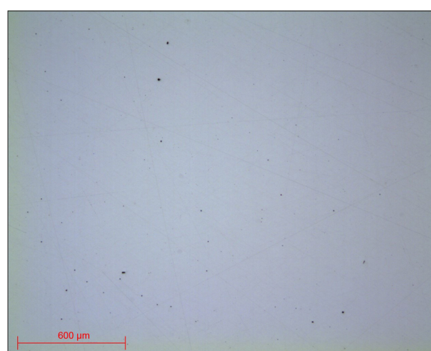
Micrographie 9 : Etat de surface NT 1µm obj x5
