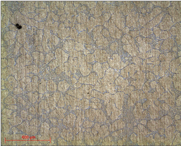
Micrographie 16 : Etat de surface RAM 3µm obj x5
