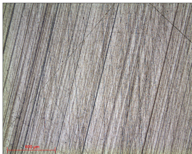
Micrographie 7 : Etat de surface I-Max R 18µm obj x5
