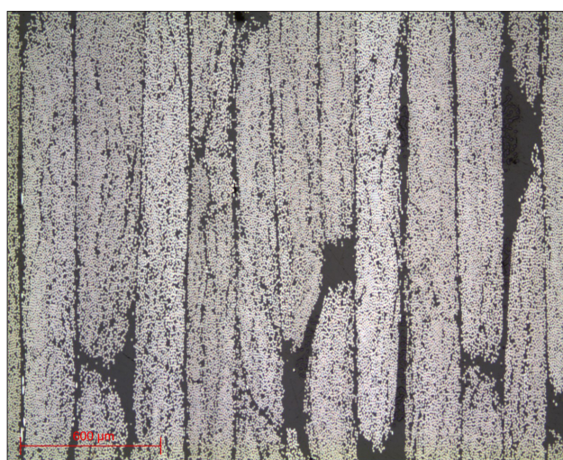
Micrographie 3 : Fibres de carbone - Etat de surface NT Al2O3 N°1 obj x5
