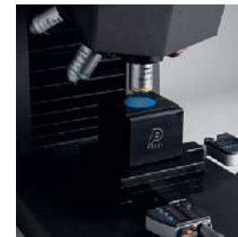
Einzel-Probenhalter Für die Nivellierung von Proben
