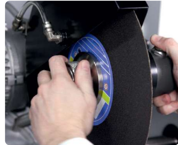
Wellenarretierung und Schnellspannmutter zum einfachen werkzeuglosen wechsel der Trennscheibe
