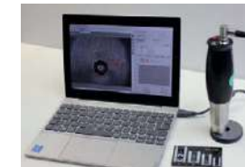
Brinell-Kamera mit Software zur automatischen Eindruckvermessung und Extraktion von Härteeindrücken
