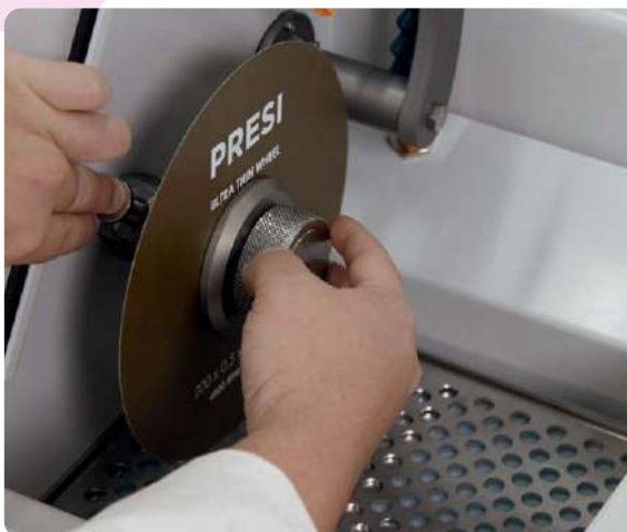
Wellenarretierung und optionale Schnellspannmutter zum einfachen werkzeuglosen Wechsel der Trennscheibe
