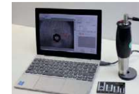
Brinell-Kamera mit Software zur automatischen Eindruckvermessung und Extraktion von Härteindrücken
