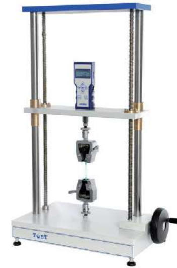
Manuelle Zweisäulenmaschine mit Kraftmessung Maximale Prüflast 5kN
