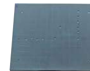
Brinell-Härtevergleichsplatte für hohe Prüflasten mit Raster
