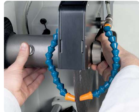
Wellenarretierung durch optionale Schnellspannmutter
