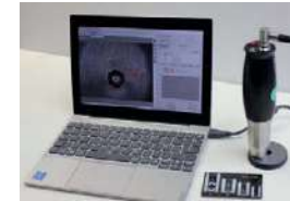
Brinell-Kamera mit Software zur automatischen Eindruckvermessung und Extraktion von Härteeindrücken
