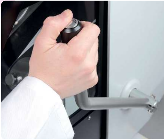
Elektromagnetische Armarretierung des Trennarms
