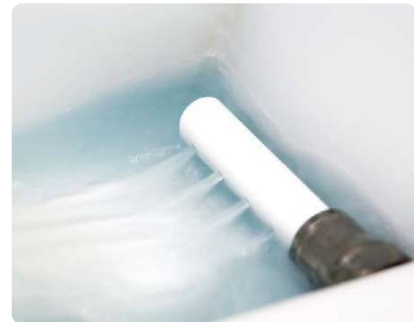
Reinigungsdüse im hinteren Bereich der Maschine
