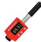
HLD Rückprallhärtemesser mit integriertem Sensor
