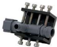
Probenhalterung für unregelmäßig geformte Proben Ref. 51716
