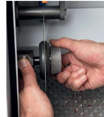
Schnellspannmutter T205/T215 Werkzeugloser Trennscheibenwechsel Ref. 51725
