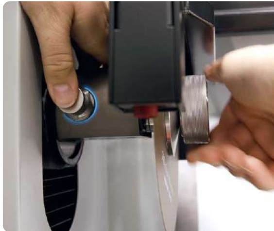
Wellenarretierung und Schnellspannmutter zum einfachen werkzeuglosen wechsel der Trennscheibe
