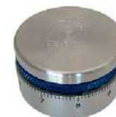
Präziser manueller Schliffhalter mit Skalierung 30x45mm Ref. 62862
