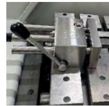
Spezial-Schnellspanner mit Wechselbacke für lange Teile Ref. 51469
