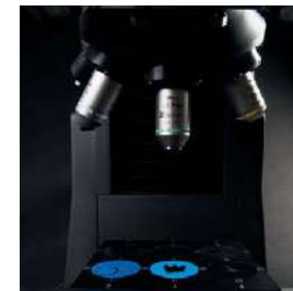
Motorisierter Revolver Bis zu 7 Positionen, einschließlich des Berührungssensors
