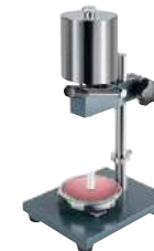
Shore-Härteprüfgerät montiert auf Messrahmen
