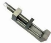
Längsschnitt-Probenhalter (Länge 53mm) Ref. 51718
