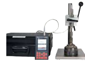
Montierter UCI-Härteprüfgerät auf Messrahmen
