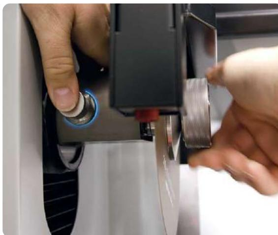
Blocage de l'arbre pour changement du disque avec écrou à serrage rapide
