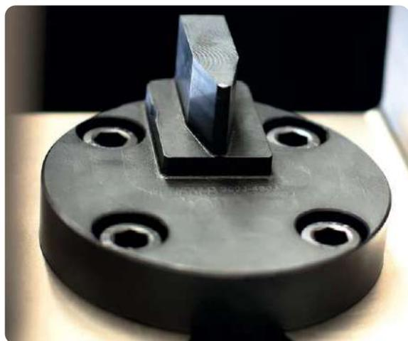
Couteaux suivant normes ISO et ASTM interchangeables facilement
