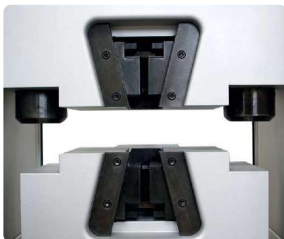
Mors de traction pour éprouvettes planes
