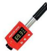
Duromètre à rebond Leeb HLD à sonde intégrée
