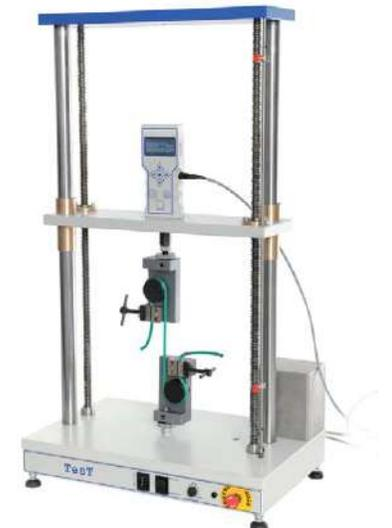
Machine motorisée avec mesure de force et de déplacement
