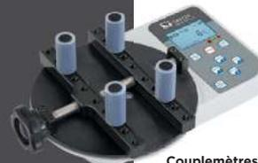
Couplemètres de contrôle de serrage de bouchon
