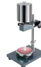
Duromètre Shore monté sur bâti de mesure
