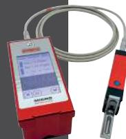
Appareil de mesure de rugosité
