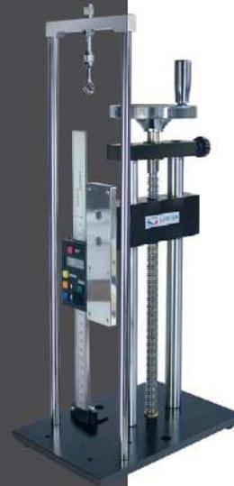
Machine manuelle avec mesure de force et de déplacement
