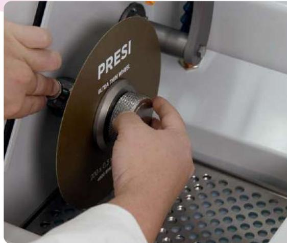
Blocage de l'arbre pour changement du disque avec option écrou à serrage rapide
