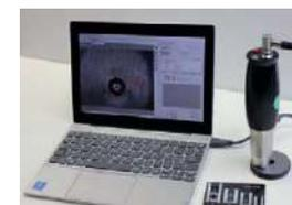
**Caméra Brinell** avec logiciel de lecture d'empreinte automatique et extraction des données de dureté
