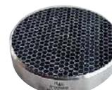
Étalon Brinell faible charge quadrillé
