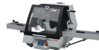
Tunnel de protection pour passage de barre côté droit Mecatome T305/ST315
