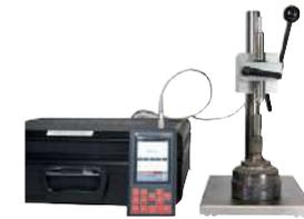
Duromètre UCI monté sur bâti de mesure
