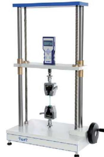
Machine manuelle bi colonne avec mesure de force
