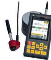
Duromètre à rebond Leeb HLD à sonde externe
