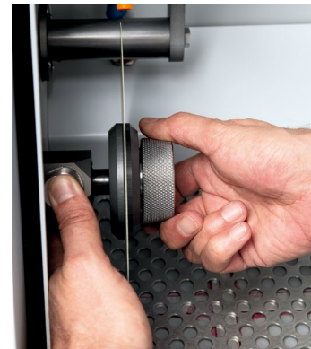
Schnellspanmutter T205/T215 Werkzeugloser Trennscheibenwechsel Réf. 51725
